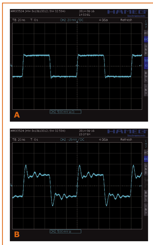
Figuur 1. 10-MHz-blokgolf met kabel en 50- \Omega -afsluiting in de scoop (A); hetzelfde signaal gemeten met probe en massadraad op de afsluiting (B).
