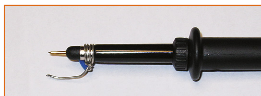
Figuur 4. Probe van Hameg met zelfgemaakte 'massaveer'. Ook hier werd de standaard massakabel verwijderd.
